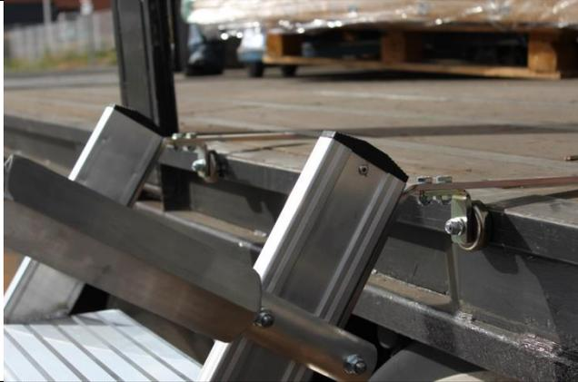
Los soportes de acero deben estar en contacto con el perfil de la caja del camión.
