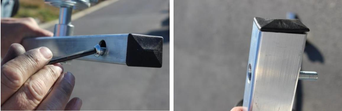
**ETAPA 2 Aflojar los pernos del tramo con peldaños y del travesaño trasero con el objetivo de ajustar los pernos en los orificios de la barra de las ruedas escamoteables**
