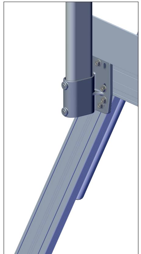
Una vez las barandillas instaladas, fijar los zócalos a los postes de las barandillas con dos tornillos autorroscantes 5,5/25.
