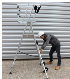
Tirer les stabilisateurs jusqu'au sol, puis les bloquer en retournant la molette
