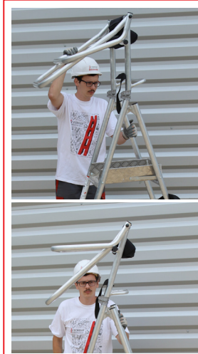
Soulever le garde-corps jusqu'à ce que l'articulation s'enclenche.
