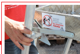
Vérifier le bon positionnement du crochet anti-soulèvement du plancher.
