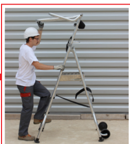
Poser les mains sur le garde-corps.
