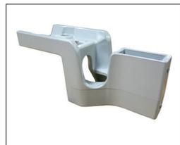
La barandilla bajo albardilla FASTGUARD es un sistema de protección colectiva anti-caída para cubiertas planas. El soporte en forma de Z es adecuado para fijarse sobre murete perimetral por debajo de la albardilla.
