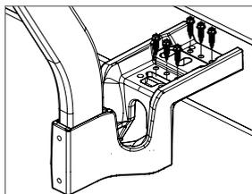
Es posible fijar el soporte a la estructura metálica con 6 tornillos auto-roscentes previo estudio de viabilidad por parte de nuestra oficina técnica, para determinar los esfuerzos de acuerdo con el soporte y la validación del proveedor de tornillería.
