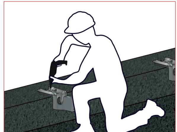
**4** - Fijar la BASE Z sobre el petril en función del soporte.
