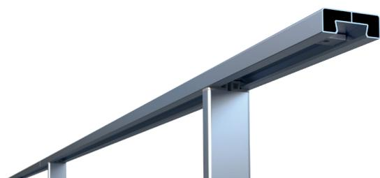
El pasamanos de la barandilla FASTGUARD es rectangular y continuo, se fija al poste mediante un sistema de cola de milano, bloqueándose con un simple giro de llave.
