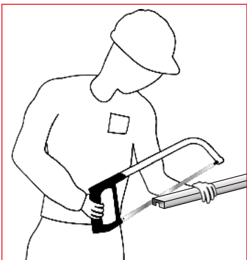
7 - Ajustez le dernier tronçon en sciant l'excédent.
