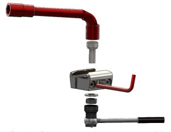
Afloje las fijaciones estándar R25 con una llave hexagonal de 6 mm y atornille la fijación del raíl al soporte con una llave de carraca con vaso de 19 mm y una 2ª llave de 19 mm. Coloque la fijación del raíl con un tornillo de acero inoxidable M12 de longitud suficiente. Los pernos deben tener un sistema antiaflojamiento. CONEKT suministra una arandela grower. Apriete el tornillo con el par de apriete correcto.
