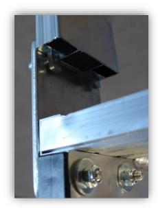
Posicionar el tramo de soporte sobre las platinas de la plataforma habiendo desatornillado con antelación los tornillos Halphen para facilitar su introducción en las ranuras del perfil. A continuación empujar hasta que esté en contacto con la plataforma y atornillar los tornillos moderadamente
