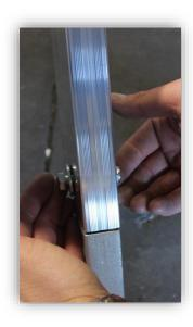
Presentar el tramo de subida en las piezas de aluminio de la plataforma. A continuación, empujar fuertemente hasta su completo ensamblaje. Atornillar los 2 tornillos de forma definitiva.
