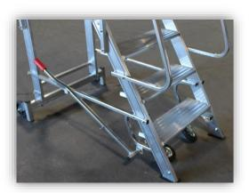
La parte superior de la barandilla de la escalera se fija con una U en aluminio justo por debajo del pasamanos de la barandilla de la plataforma. La parte inferior de la barandilla de la escalera se fija gracias al tornillo Halphen situado en el tramo de subida. Repetir la operación en ambos lados.
