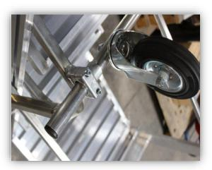
Preparar los tornillos. Posicionar el tornillo corto en la parte inferior y el tornillo largo en la parte superior. Con una llave Allen desatornillar completamente la pieza en fundición de aluminio y posicionar la barra móvil. Colocar de nuevo la ½ de la pieza de fundición y atornillar de nuevo.
