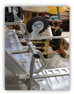
Colocar la barra con su tornillería Halphen empezando por el tramo de soporte y terminando con el tornillo superior de la barra móvil, Una vez posicionado proceder a nivelar la barra. Realizar la misma operación por el otro lado. La barra de unión tiene tres orificios consecutivos que se colocan en el lado la palanca. Posteriormente atornillar el conjunto.
