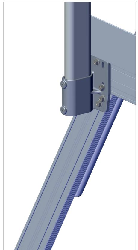
Una vez que las barandillas estén colocadas, posicionar el zócalo a los postes de la barandilla con dos tornillos autorroscantes 5,5/25.
