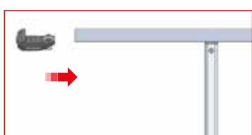
11 - Posez la main courante sur les montants. Fixez la en vissant la vis HC M08x40. Couple de serrage recommandé 15 N.m.
