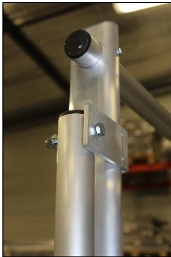
3.3 B Fixation du poteau en bas de la main courante : à l'équerrage et au bord de la main courante. Utilisation des vis H M8X60.
