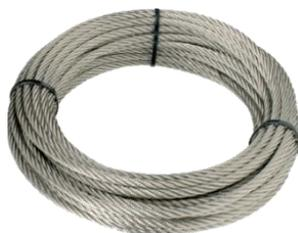
El cable de línea de vida Conekt está compuesto por 7 hebras de 19 hilos de acero inoxidable 316.
