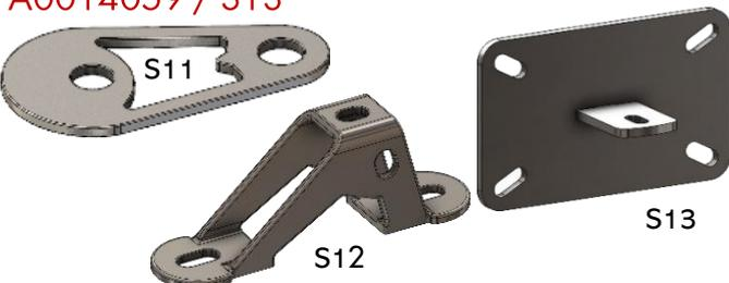
La platina de inicio S11 está fabricada en acero inoxidable 304 y puede montarse en un poste. Las platinas S12 y S13 son de acero galvanizado y deben fijarse con 2 o 4 tornillos M12 de acero inoxidable.
