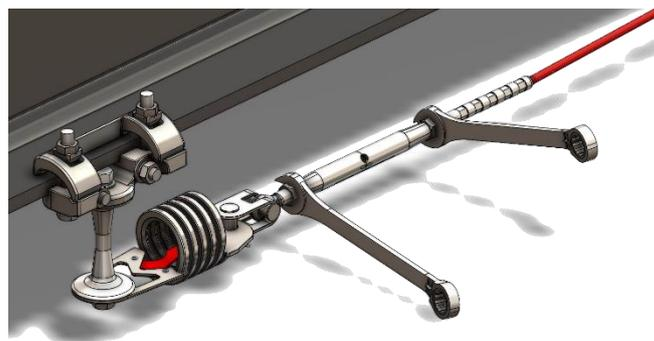
El plomo se coloca entre el orificio situado en el centro del cuerpo del tensor y la abrazadera del tensor.
