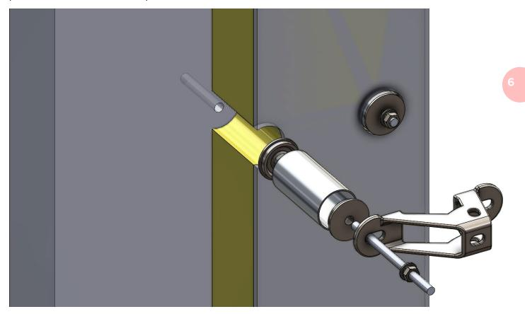
El sistema se sujeta con 4 tornillos M12 de 80 mm de longitud y 2 tornillos de unión entre los soportes de las grapas (en amarillo). Los tornillos de conexión M12 deben medir L+60 mm. L representa la anchura del ala. Este sistema puede adaptarse a alas de 3 a 25 mm de grosor y de 60 mm a 1 m de ancho. Debe colocarse un tornillo M12 de 40 mm en el punto de montaje para recibir el soporte de la línea de vida.
