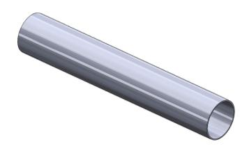
El tubo de extensión es un tubo de aluminio de 60 mm y 3 mm de grosor. Se puede combinar con soportes tipo grapa o con articulaciones CONEKT mediante un perno roscado M12.
