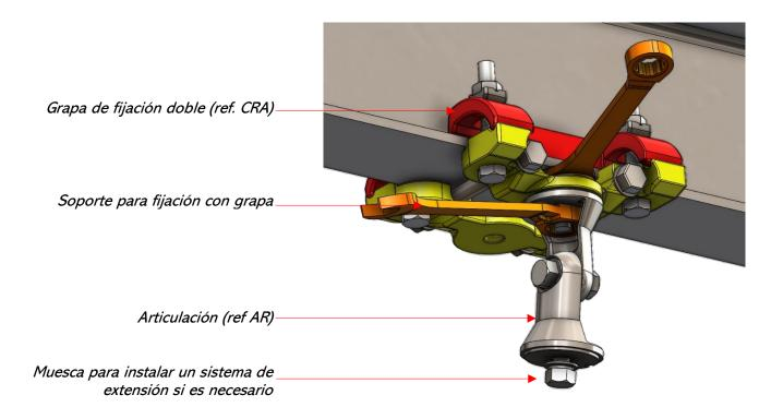
El sistema de extensión consta de un tubo de aluminio de 60\*3, un perno roscado M12 y un soporte de alargador SR para recuperar el nivel. El perno roscado debe medir la longitud del tubo +50 mm:
