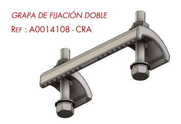
Grapa de fijación doble de acero galvanizado, con 2 tornillos M12 de 80 mm de longitud. La grapa de fijación doble puede utilizarse para «sujetar» el ala de un perfil metálico de 3 a 25 mm de grosor. La pieza tiene un «agarre» para mejorar su resistencia al deslizamiento.
