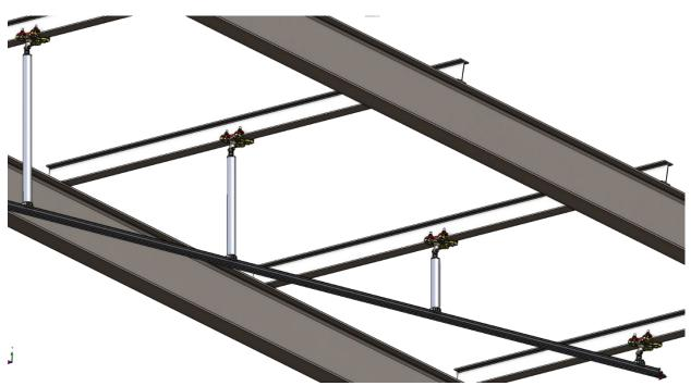
El sistema se sujeta con 4 tornillos M12 de 80 mm de longitud y 2 tornillos de unión entre los soportes de las grapas (en amarillo). Los tornillos de conexión M12 deben medir L+60 mm. L representa la anchura del ala del perfil metálico. Este sistema puede adaptarse a alas de 3 a 25 mm de grosor y de 60 mm a 1 m de ancho. Debe colocarse un tornillo M12 de 40 mm durante el montaje para recibir el soporte de la línea de vida.
