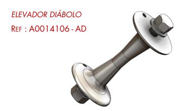
El diábolo CONEKT puede utilizarse para elevar un componente de la línea de vida 100 mm. Debe utilizarse para montar un absorbedor o un tensor CONEKT en los kits de fijación de la cubierta ICZ o ICJD.
