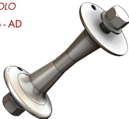
El diábolo CONEKT puede utilizarse para elevar un componente de la línea de vida 100 mm. Debe utilizarse para montar un absorbedor o un tensor CONEKT en los kits de fijación de la cubierta ICZ o ICJD.
