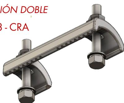
Grapa de fijación doble de acero galvanizado, con 2 tornillos M12 de 80 mm de longitud. La grapa de fijación doble puede utilizarse para «sujetar» el ala de un perfil metálico de 3 a 25 mm de grosor. La pieza tiene un «agarre» para mejorar su resistencia al deslizamiento.
